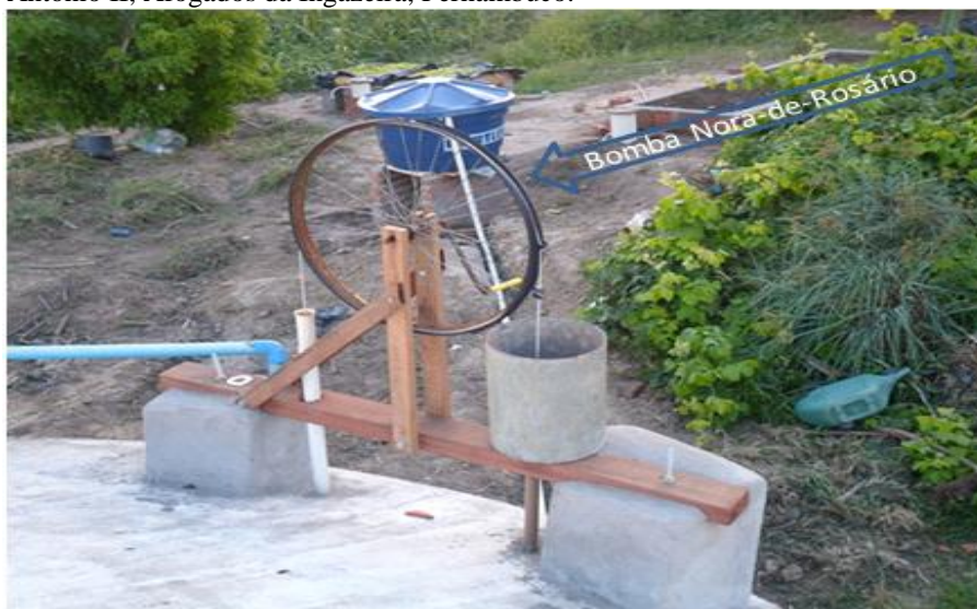
Figura 11 – Bomba Nora-de-Rosário acoplada à cisterna calçadão. Comunidade de Santo Antônio II, Afogados da Ingazeira, Pernambuco.
